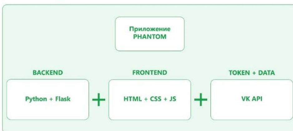
Рисунок 5 - Схема архитектуры ПС Phantom
