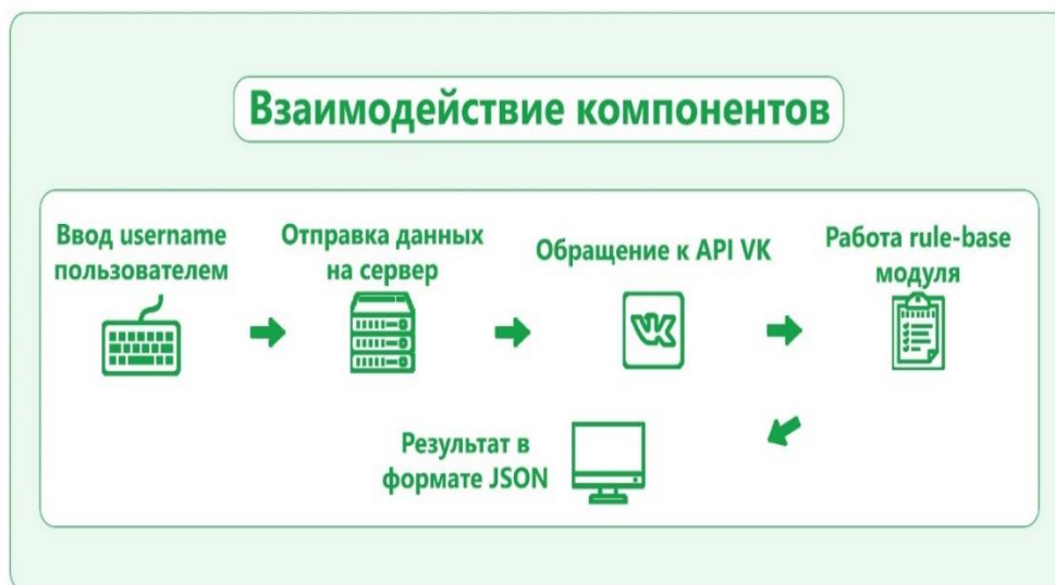
Рисунок 6 - Схема взаимодействия компонентов ПС
