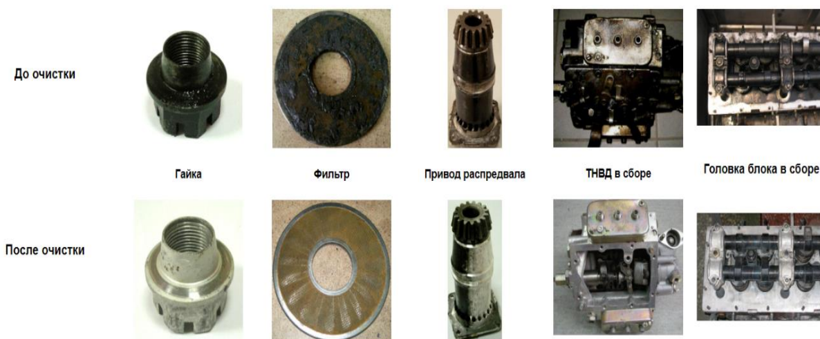
Рисунок 5 – Пример ультразвуковой очистки деталей дизеля
