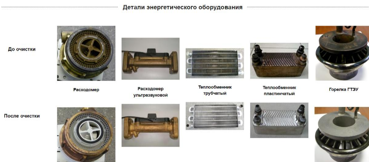
Рисунок 4 – Пример ультразвуковой очистки деталей энергетического оборудования
