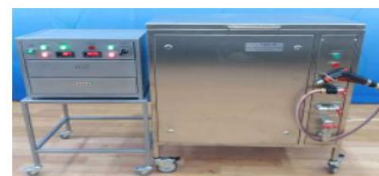
УЗС8-70 70 литров, ультразвук 1600 Вт
