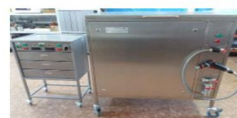
УЗС12-140 140 литров, ультразвук 2400 Вт
